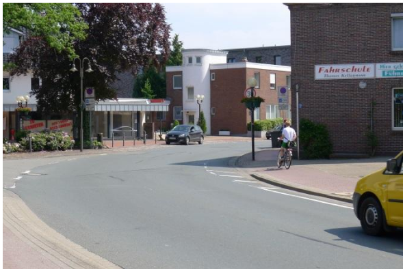
Übergang vom gemeinsamen Geh-/Radweg zur Fahrbahnführung; Bahnhofstraße
