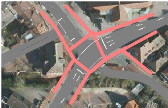
Variante 5: Alte Mühlenstraße verschwenkt, Gebäudeabriss
